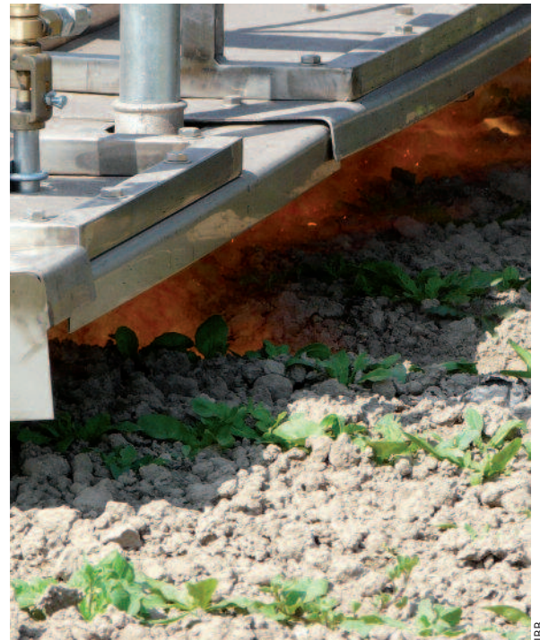
Un désherbage thermique peut être effectué en pré-levée et un second jusqu'au stade 3-4 feuilles de l'endive.
