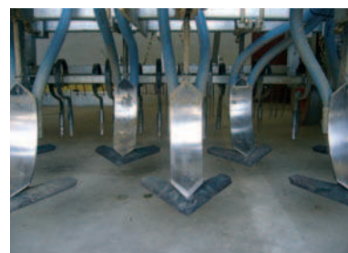
Pattes d'oie avec en bleu les tubes distribuant les graines. Les dents visibles à l'arrière sont destinées à affiner et mélanger la terre après le semis.
