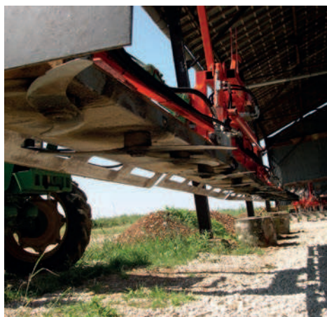
Écimeuse dépliée, repliée et vue sur les couteaux
