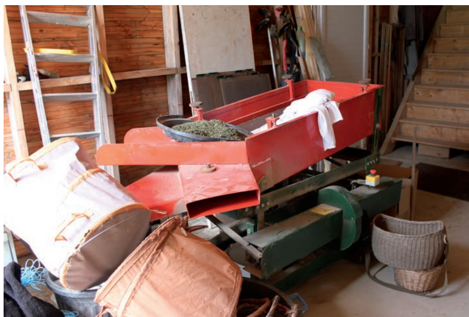
Matériel autoconstruit pour trier les plantes sèches à petites feuilles
