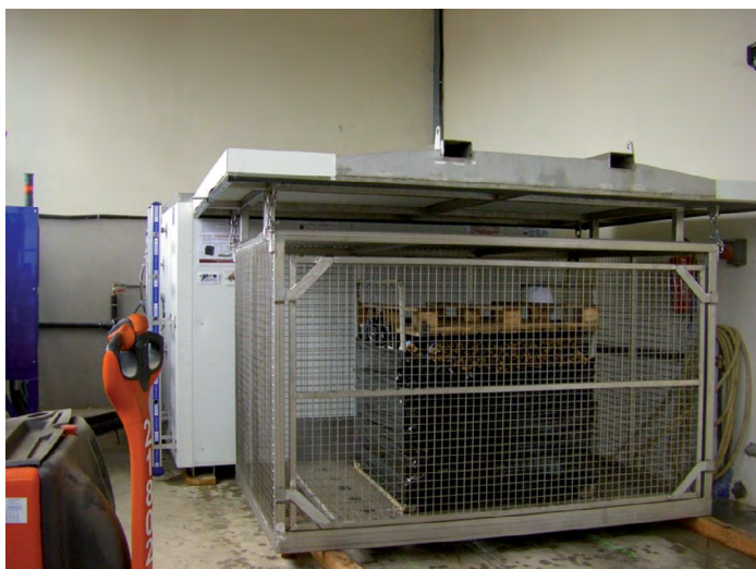
Machine de traitement à l'eau chaude de la pépinière Tourette
