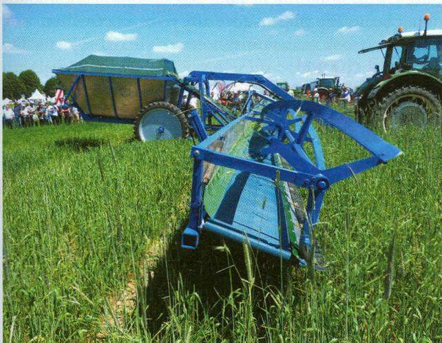
Après être coupées, les adventices sont conduites par un tapis d'évacuation vers un tapis élévateur central qui les évacue dans une trémie de 6 m<sup>3</sup> placée à l'arrière de la machine.
