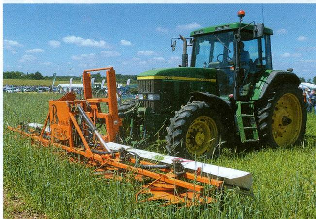
Selac est une écimeuse de 6,6 m avec couteaux et contre-couteaux présentée en attelage frontal et centrale hydraulique à l'arrière.
