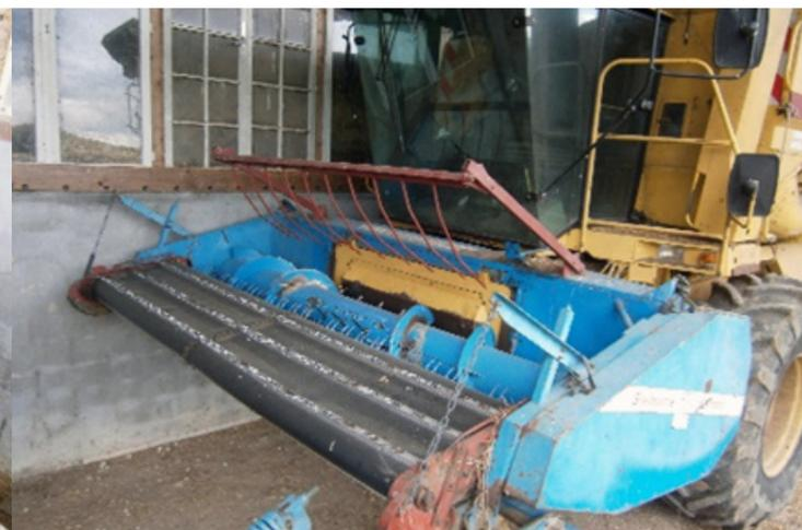
Le pick-up permettant de charger l'andain dans la moissonneuse. Lors de la récolte on cherche à avoir le pick-up le plus haut possible pour ne pas l'abîmer et éviter de charger une pierre.
