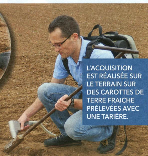
L'ACQUISITION EST RÉALISÉE SUR LE TERRAIN SUR DES CAROTTES DE TERRE FRAICHE PRÉLEVÉES AVEC UNE TARIÈRE.
