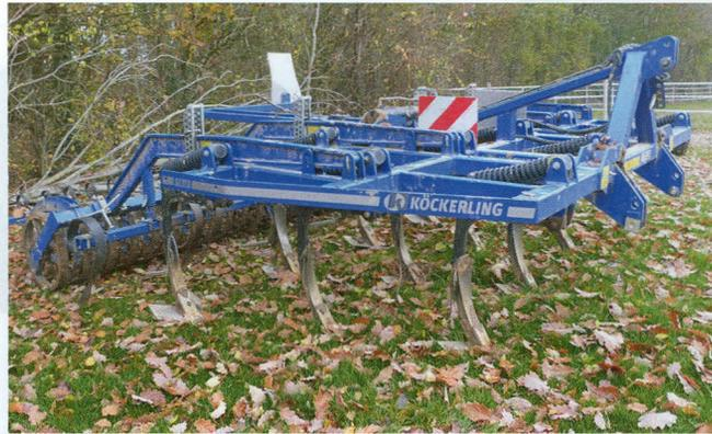
La plupart des déchaumages sont effectués avec un Köckerling Trio en 4 m. L'outil est muni de 13 dents à ailettes sur 3 poutres, de niveleurs, d'un rouleau de 530 mm ainsi que de herse peignes de 13 mm à l'arrière.
