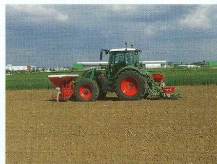
Chantier de semis de maïs en 2016. À l'avant du tracteur est monté un semoir Sepeba Maxidoseur dont les descentes localisent l'engrais organique de part et d'autre des rangs de maïs.
