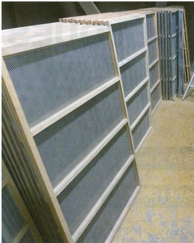
Les grilles équipant le nettoyeur-plan ont une surface d'un m<sup>2</sup> chacune.
