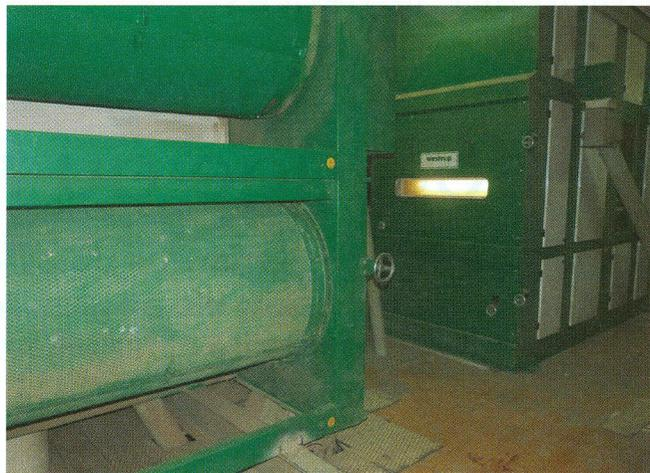
Avant d'être envoyés sur la table densimétrique, les lots de semences sont passés au nettoyeur-plan à 18 grilles Westup (6 étages de 3 grilles) à droite puis au trieur alvéolaire Westup. Si besoin, un épierrage est réalisé.
