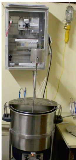
Prototype de thermisation du lait au Pradel pour une double utilisation élevage et fromagerie.
